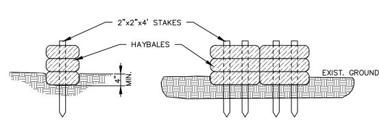
NOTE: HAYBALES TO BE EMBEDDED 4" IN EXISTING GROUND BUTTED END TO END/STAKED SECURELY.
